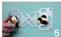
5 Faire descendre les raccords sur la platine. Visser les contre-écrous manuellement puis terminer le serrage à la clé.
