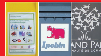
Marquage par photo injection | Autocollant | Marquage à chaud
