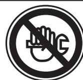
**Interdiction** : ne pas entreprendre d'intervention sur cet appareil, sans avoir débranché électriquement et sans avoir vidé le réservoir.
