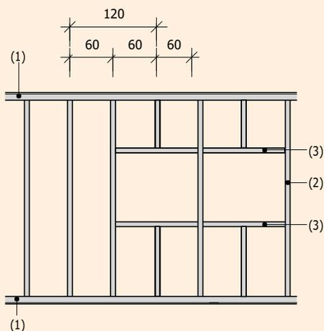
Mise en œuvre des ouvertures pour parois vitrées dans la cloison FERMACELL (cotes en cm)
