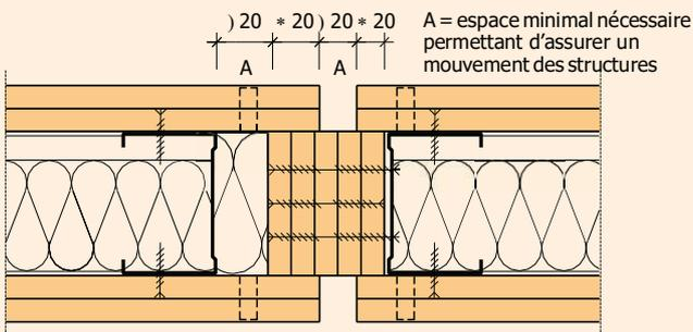
Cloison distributive FERMACELL, à parement double, CF 120. Joint de dilatation avec bandes de plaques superposées
