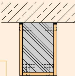
**Revêtement à parement simple d'une poutre bois pour une protection au feu sur 3 côtés (CF 30 minutes selon normes DIN)**
