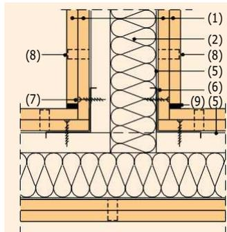
Liaison en T de 2 cloisons avec parement interrompu et profilé d'angle rentrant
