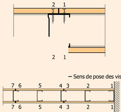
**Disposition des plaques d'une cloison FERMACELL à parement double**
