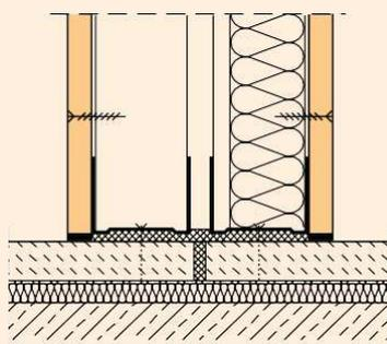
Cloison séparative à ossature parallèle posée sur chape flottante avec interruption de la chape sous la cloison  $R_{L,w,R} = 55$  dB
