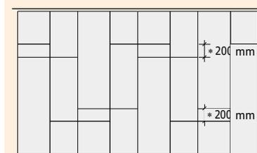
Sur les cloisons FERMACELL, les joints horizontaux seront réalisés à l'aide de la colle pour joint, tel que décrit au paragraphe 2.8.
