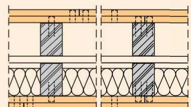
Cloison FERMACELL à ossature parallèle et parement double avec isolant interne
