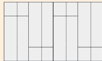
**Disposition des plaques d'une cloison FERMACELL à parement simple**
