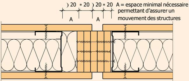
Cloison distributive FERMACELL, à parement simple, CF 30/CF 60. Joint de dilatation avec bandes de plaques superposées
