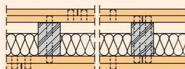
Cloison FERMACELL à ossature simple et parement double avec isolant interne
