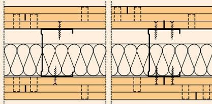
Cloison FERMACELL à ossature simple et parement triple. 2<sup>ème</sup> et 3<sup>ème</sup> parements agrafés au premier parement/au parement précédent
