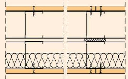
Cloison FERMACELL à ossature parallèle et parement simple. Montants disposés séparément (à gauche) et/ou assemblés par des bandes isolantes autocollantes (à droite)
