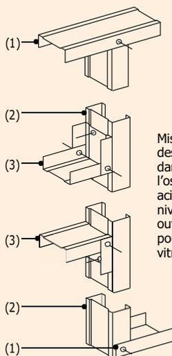
Mise en œuvre des profils dans l'ossature acier au niveau des ouvertures pour parois vitrées
