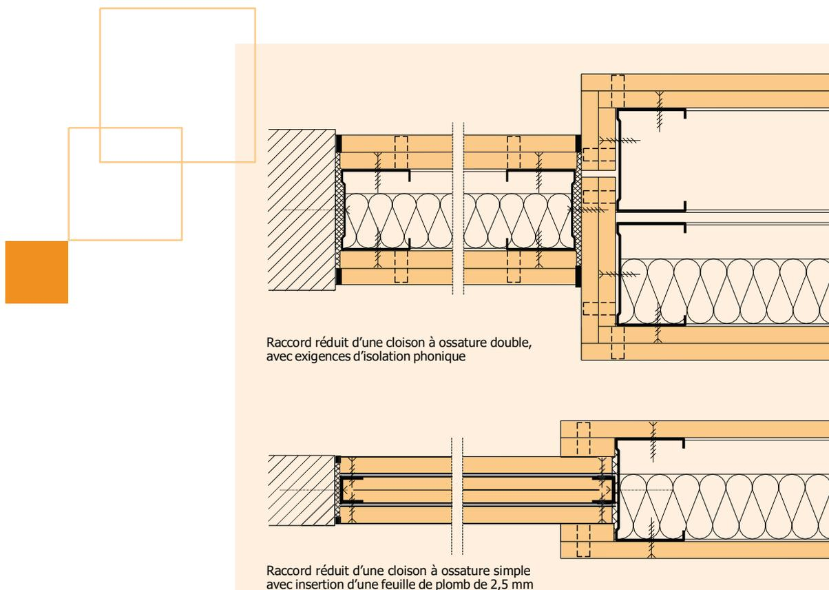
Les raccords coulissants et/ou réduits au gros œuvre conduisent à une réduction des performances en matière d'isolation phonique et/ou de protection au feu des cloisons. Il convient d'en tenir compte en amont du projet.
