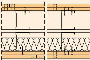
Cloison FERMACELL à ossature parallèle et double parement. Le 2<sup>ème</sup> parement (plaques de la deuxième couche) est agrafé sur le 1<sup>er</sup> parement (plaques de la première couche en contact avec l'ossature)
