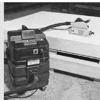
Scie circulaire portable avec dispositif d'aspiration
