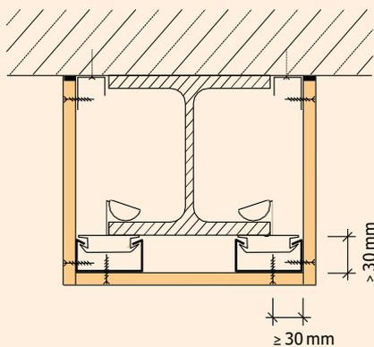
**Revêtement à parement simple d'une poutrelle acier pour une protection au feu sur 3 côtés (CF 30 minutes selon normes DIN)**
