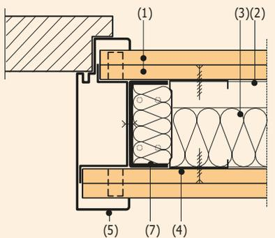
Fixation de l'huissierie à des profilés de renfort en U, cloison à parement double
