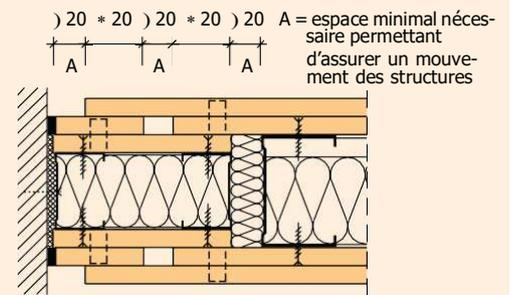
Cloison FERMACELL, à parement double, CF 120, raccord de cloison ou/et la façade coulissant avec bandes de plaques fixées mécaniquement dans deux montants
