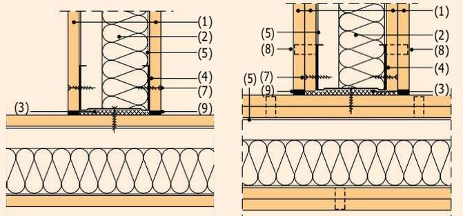
Liaison en T de 2 cloisons à parement simple ou double.
