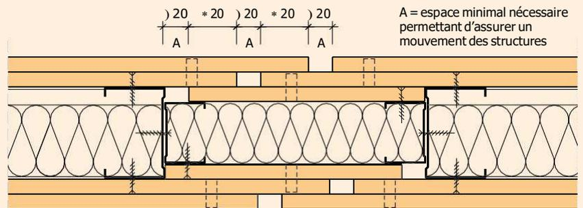
Cloison distributive FERMACELL à parement double, CF 120.
