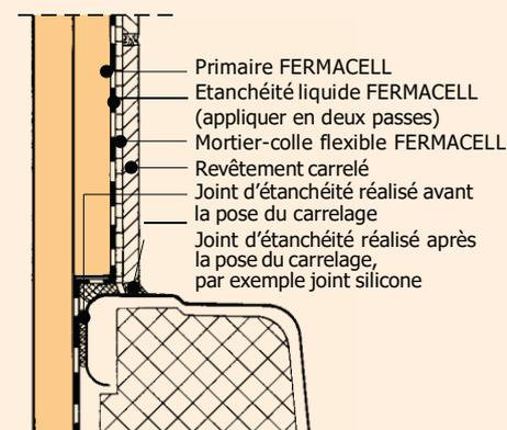
**Raccord d'un bac à douche ou d'une baignoire à une paroi FERMACELL à parement simple sous l'élément sanitaire et à parement double au dessus de l'appareil sanitaire**
