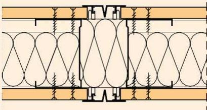
Cloison distributive FERMACELL, à parement simple, sans exigence en matière de résistance au feu. Joint de dilatation avec profilé adapté
