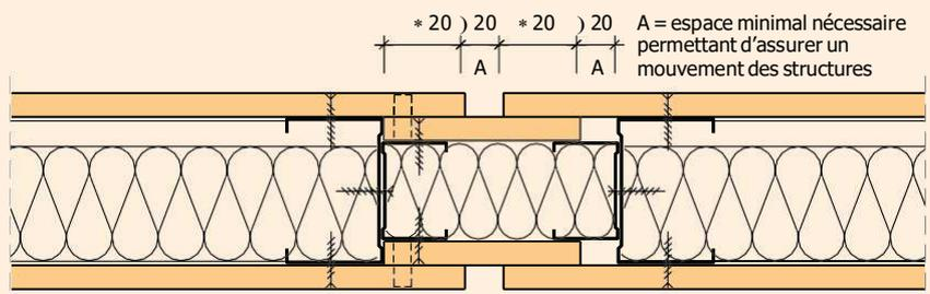
Cloison distributive FERMACELL à parement simple, CF 30/CF 60.
