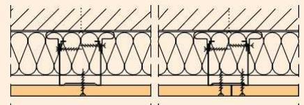
Doublage en demi cloison à parement simple. Montants fixés au gros œuvre par étriers à serrage ajustable
