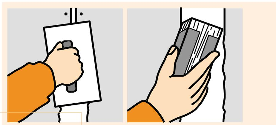
Enduire les joints et les têtes de fixation
