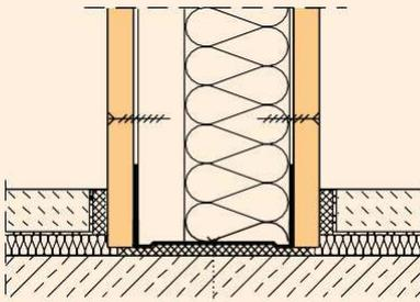
Cloison distributive sur chape flottante avec joint de dilatation sous la cloison  $R_{L,w,R} = 70$  dB
