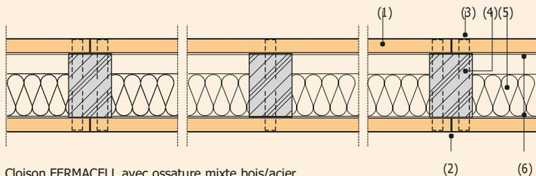
Cloison FERMACELL avec ossature mixte bois/acier
