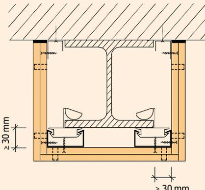
**Revêtement à parement double d'une poutrelle acier pour une protection au feu sur 3 côtés (CF 90 minutes selon normes DIN)**
