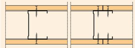
Cloison FERMACELL à ossature simple et parement simple sans isolant interne
