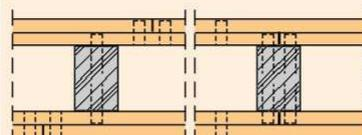
Cloison FERMACELL à ossature simple et parement simple sans isolant interne
