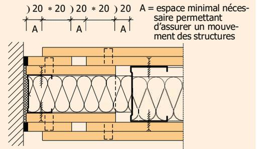
Cloison FERMACELL, à parement double, CF 90, raccord de cloison ou/et la façade coulissant avec bandes de plaques fixées mécaniquement dans un montant
