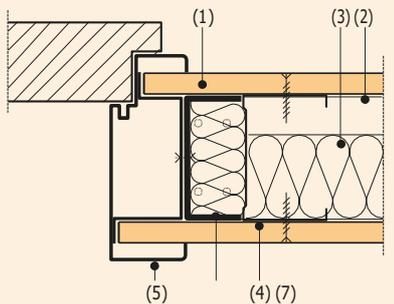
Fixation de l'huissierie à des profilés de renfort en U, cloison à parement simple
