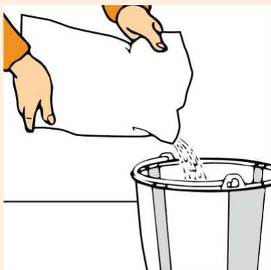
Verser l'enduit pour joint dans de l'eau
