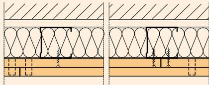
Doublage en demi cloison à parement double
