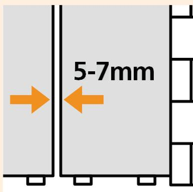
Respecter une largeur de joint de 5 à 7 mm ce qui correspond à environ la moitié de l'épaisseur d'une plaque
