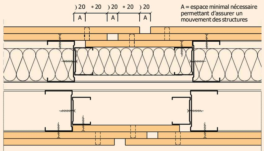
Cloison distributive FERMACELL à ossature parallèle et parement double, CF 120.
