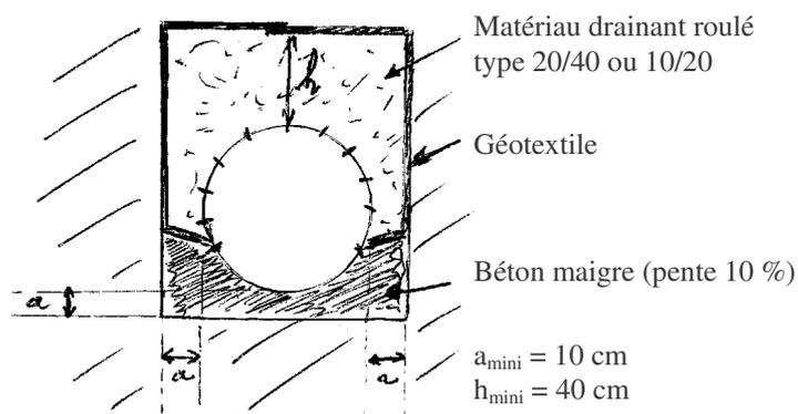
Cette technique est la plus efficace. Elle est recommandée notamment par la SNCF et par d'autres maîtres d'œuvre. Elle est cependant plus onéreuse et plus difficile à mettre en œuvre.
