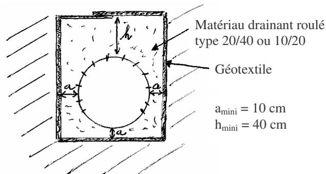
Cette technique est celle utilisée traditionnellement en France pour drainer les corps de chaussée. Notons que le géotextile peut être également directement posé autour du drain même si cela est moins efficace.
