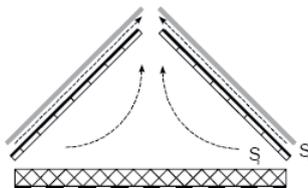
2/ Comble aménagé avec lame d'air ventilé entre isolant thermique.
