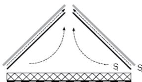
2/ Comble aménagé avec lame d'air ventilé entre isolant thermique.
