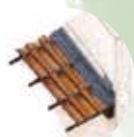
**Bande d'étanchéité et solin :** En tête de pente. En longueur intérieure ou égale à 1,5 mètre, épaisseur 1,5 mm.
