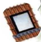
**Fenêtre de toit :** Bavette d'étanchéité en plomb.
