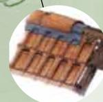
**Faitage :** A pour but de garantir l'étanchéité de la toiture à la jonction horizontale de 2 versants d'une même toiture.
