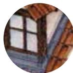
**Lucarne :** Bande d'étanchéité ou bavette de plomb et raccordement par noquet sur la rive couronnée par une bande porte solin.
