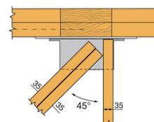
ETC485R Assemblages 2 éléments 1 arêtier double - 1 empannon
