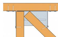
ETC434 Assemblages 2 éléments 1 arêtier simple - 1 empannon
