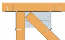
ETC434 Assemblages 2 éléments 1 arêtier simple - 1 empannon
