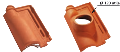
Tuile chatière Romane (section avec grille = 50 cm 2 ) Réf. 110.21
