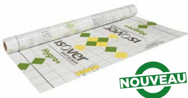
Membrane composée d'un film quadrillé à base de polymère technique contrecollé sur un voile non tissé, dont la résistance à la diffusion de la vapeur d'eau (Sd) varie en fonction de l'humidité relative, entre 18 et 48 m. Elle est quadrillée pour faciliter la découpe et la mise en œuvre.
